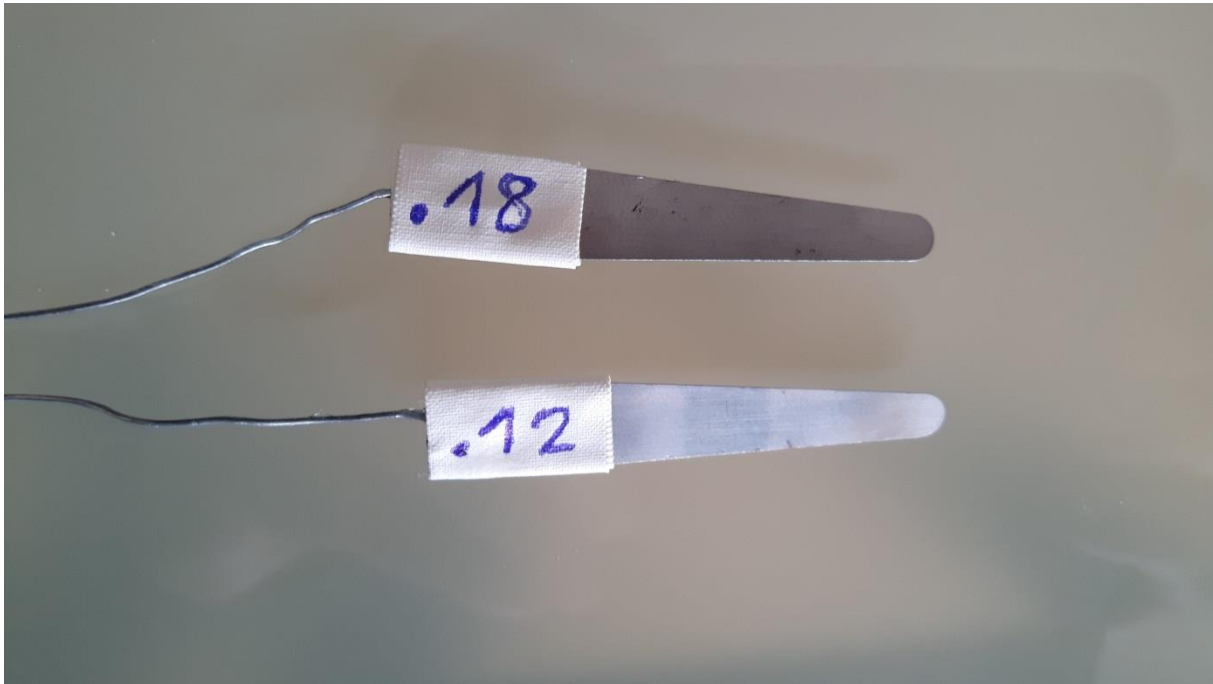
Abb. 2: Fühlerlehren mit aufgeklebter Drahtsicherung gegen Herunterfallen
